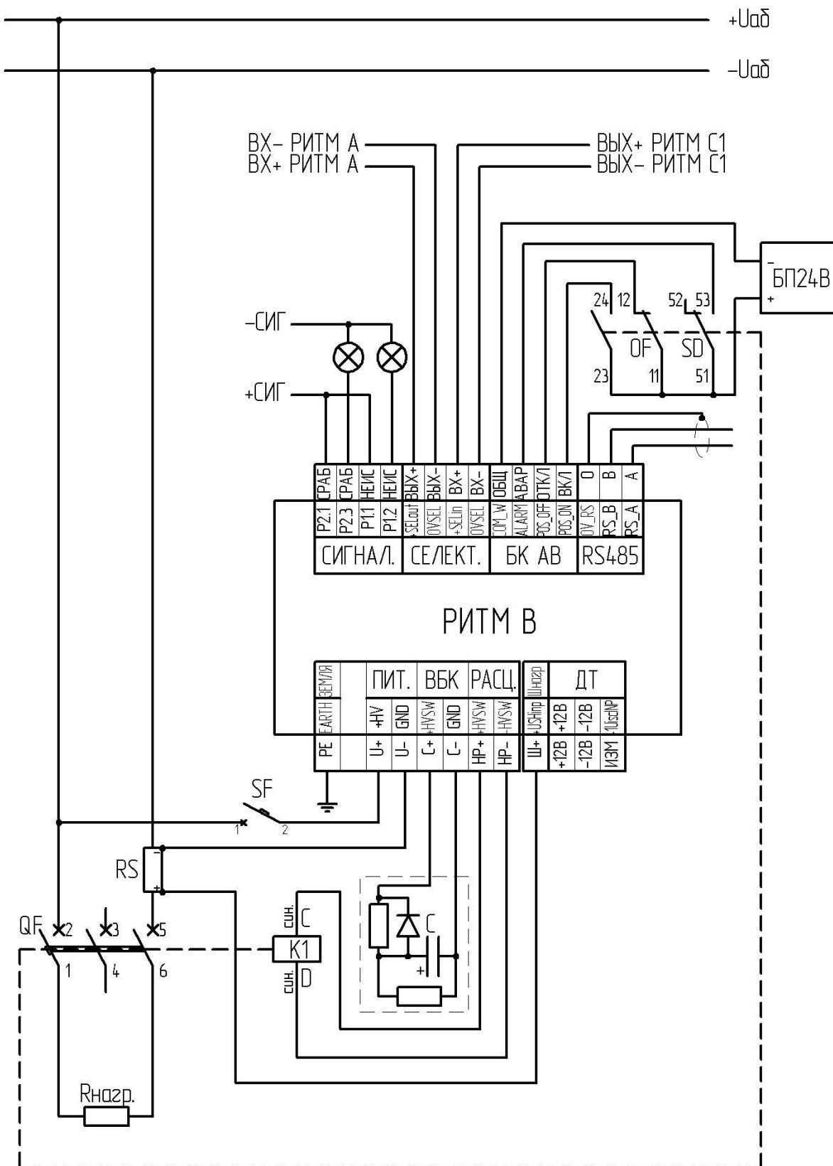
Рис.1 – Схема подключения реле РИТМ.
