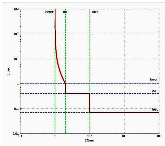
характеристики канала перегрузки  $\alpha$ .
